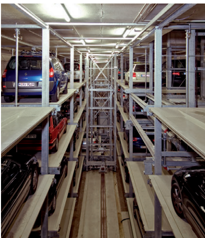
Das Regalbediengerät verfährt in X, Y und Z Bewegungen zur angewählten Palette und zieht sie aus dem Regal.
